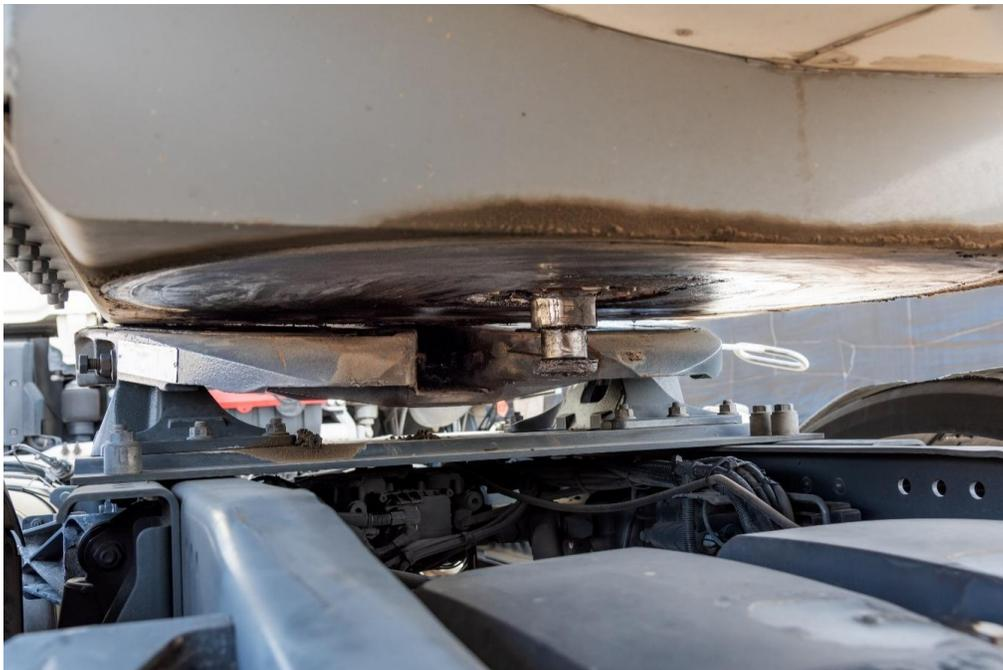
在联结的过程中，钳口（第五轮上的一个组成部分）应夹住主销，但若设备维护不当则可能会使其难以完全夹住。特别是，当涂在第五轮上的润滑油太厚，可能会导致钳口与主销没有完全联结，而只是部分联结。过厚的润滑油也可能使驾驶员看不到第五轮联结不当。如果钳口只是部分联结，那么当行驶在道路上时所产生的振动、突然的制动或货物的移动都可能会导致第五轮脱离主销。
